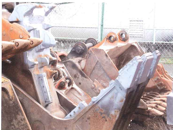
1.2～1.6㎡兼用機マグナム3500、自社の修理工がツース交換実施。
