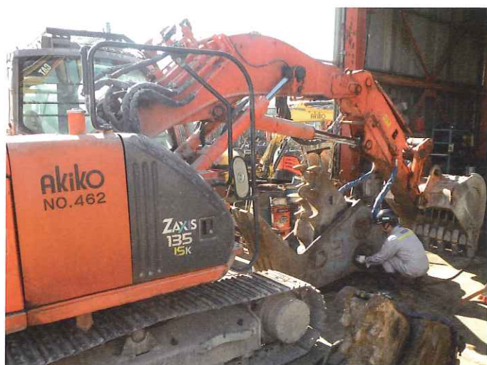
自社修理工場内での点検作業、出荷準備として稼働確認。
