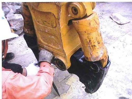
SDS30の場合には、外の置き場からRCアームを手で運んでくれますので、時間が短縮され、そして何より労力がとても少なく済みます。現場でのアーム交換作業は2名で15分程度でできるのでこれも簡単ですね。外して使わないアームは同様に手で運び出して、置き場に戻すことが容易にできます。手で持てる重量だから楽なのです、文字通りに手軽なのです。
