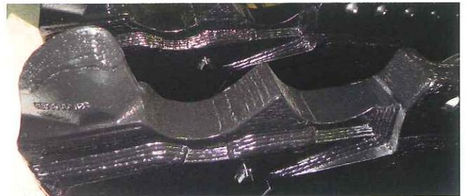
サイズや高強度なコンクリートの破碎に対応するには、ツースが2つあると力が分散してしまうのがもったいないと考えており、このサイドツースを撤去してしまい、先端のフロントブレーカー1本に破碎力を集中させるようにすることで、より大きな破碎力が実現されるのではと思いました。実際にこの現場でやってみたのですが、
