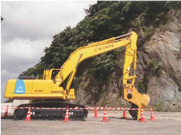
人が作業しないのですから事故は起りえません。転倒したり、重機に接触したり等の危険性はもうないのでです。この導入で、確実に鉄筋回収作業での安全を確保できたと思っています。
