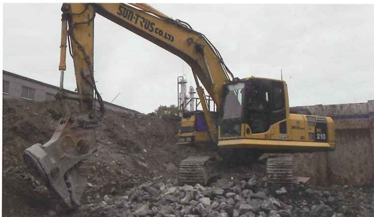
大きなサイズのガラや 2 次製品も受け入れるサントラスリサイクルセンター。大きなサイズのガラを破碎するブレーカーと、2 次製品を小割して細い鉄筋を回収するマグネット付小割機コスモ 2000（写真右）。新たに設置されたスロープによって荷降ろしの際の内容物の確認もスムーズになり作業効率を向上させた（写真左）。
