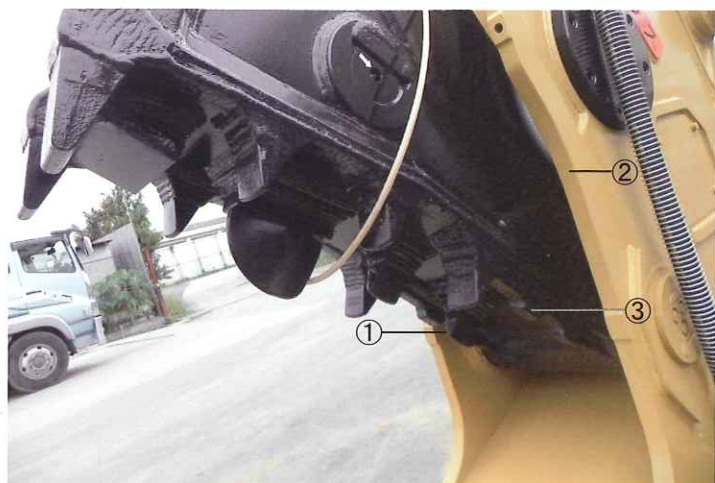
強化仕様のコスモ2000の主な改造点（写真上右左）。①カッターブレードを撤去して代わりに破碎ツースを設置 ②本体フレーム板厚をアップ ③破碎面を耐摩耗仕様に改造 ④ツース長を60ミリ延長、ツース表面にウエアプレート（耐摩耗材）を設置 ⑤緩やかなカーブに変更し更に板厚もアップ
