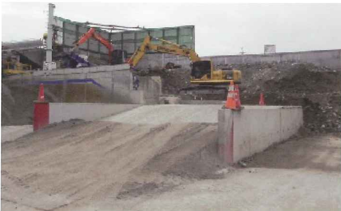
大きなサイズのガラや 2 次製品も受け入れるサントラスリサイクルセンター。大きなサイズのガラを破碎するブレーカーと、2 次製品を小割して細い鉄筋を回収するマグネット付小割機コスモ 2000（写真右）。新たに設置されたスロープによって荷降ろしの際の内容物の確認もスムーズになり作業効率を向上させた（写真左）。
